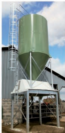
Silo acier toiture élargie 2 aliments
