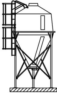
**SILOS 3.5 à 9 m<sup>3</sup> (à plan de joint horizontal)**
