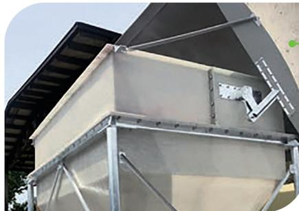
Treuil à actionnement manuel pour l'ouverture et la fermeture du chapeau
